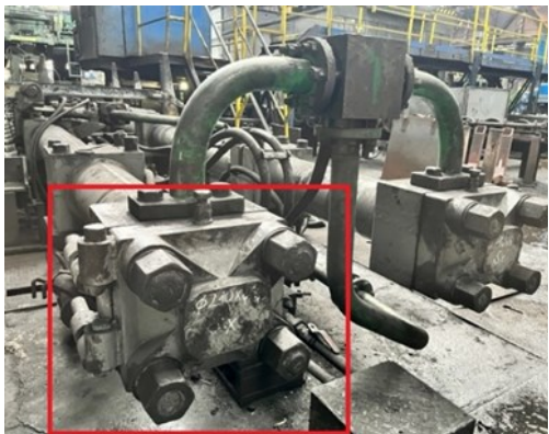
Přední a zadní část podavače, kde dochází k netěsnosti a četným opravám
